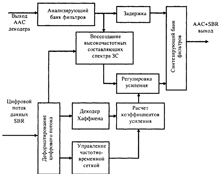
Рис. 12.10. Структурная схема, иллюстрирующая процесс декодирования звуковых сигналов при использовании методов MPEG-4 AAC и SBR
